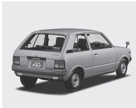
リアのハッチは荷室床面から大きく開き、可倒式リアシートと相まって200kgの積載量が確保されている。
