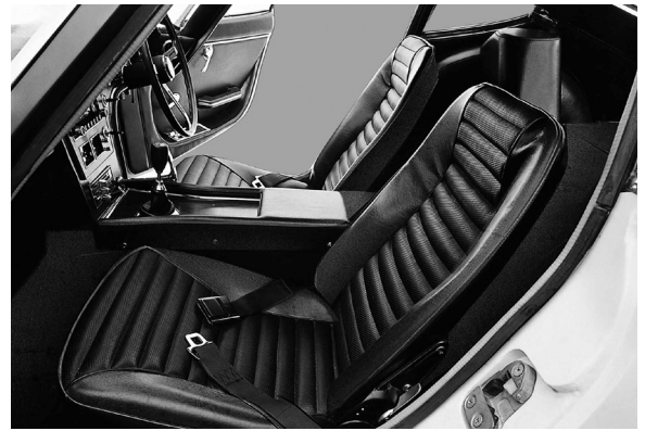
低い車高ながらも室内は調整可能なハンドル及びリクライニング付シートにより、人間工学的に最良の操縦性が得られるようにレイアウトされていた。
