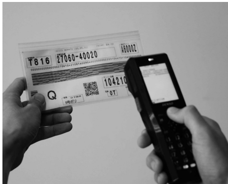
左手に持つ「かんばん」は、細長いNDコードと正方形のQRコードが混在する過渡期のもの。QRコードの読取り機器が普及するに伴い、NDコードは印刷されなくなった。
