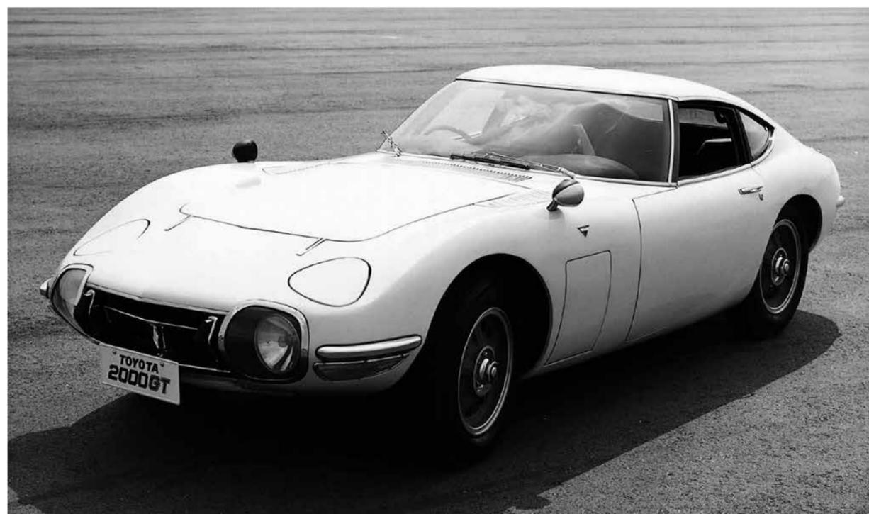
空力的に優れ、流麗かつ格調高い2ドア2シーターのファストバック型クーペのスタイリングは日本人デザイナーによるもので、わが国初のリトラクタブルヘッドランプも採用されていた。
