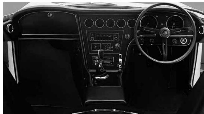
高速ツーリングに必要な計器類は、全て高級木材製のパネル奥深く、ドライバーの視線に合うよう傾斜させて配置されていた。
